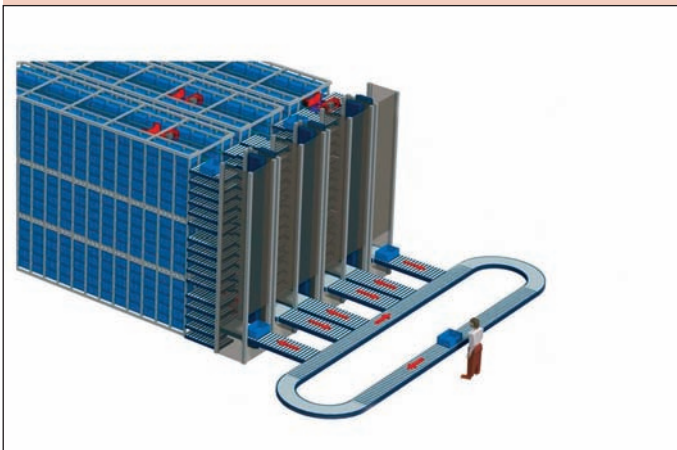
Anlagentyp 2, die Hochleistungs-Klasse mit bis zu 800 Doppelspielen pro Stunde und Regalgasse
