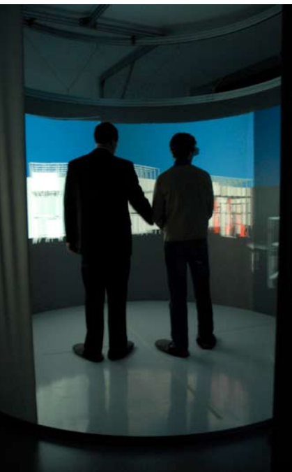
Der Virtual Reality-CAVE ist Bestandteil des Logistiklabors. Es ermöglicht die virtuelle Lager-Nachbildung.
