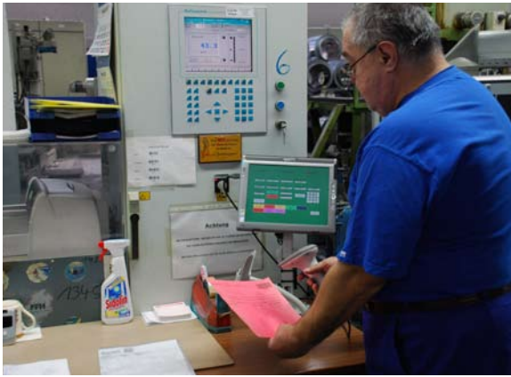
An den Arbeitsstationen von EppsteinFOILS wird Material per Scanner und Pentop-PC mit Touchscreen angefordert
