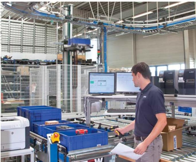
**Weitere vier Kommissionierarbeitsplätze sind an das AKL angeschlossen; mit Pick&Pack wird kein Auftragsbehälter als Zwischenschritt benötigt**
