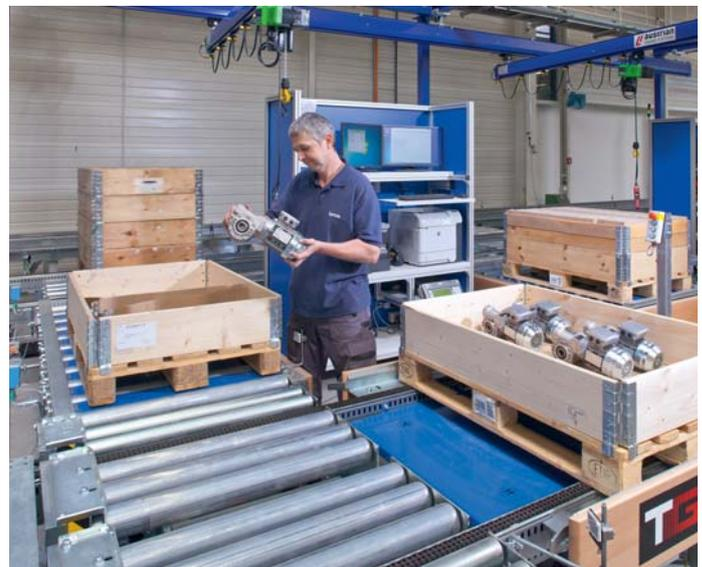
**Im Anschluss an das automatische Palettenlager befinden sich vier Kommissionierarbeitsplätze; ein manuelles Handling der Paletten ist bei „Ware zum Mann“ nicht nötig**
