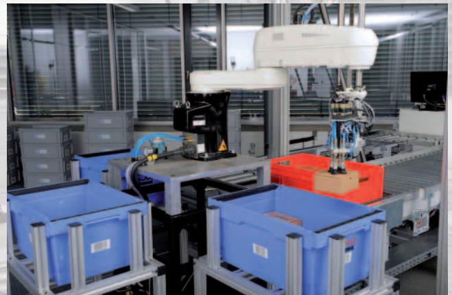
Die vollautomatische Roboterkommissionierung viapick ist in das Warehouse Management System viad@t 7.1. integriert.
