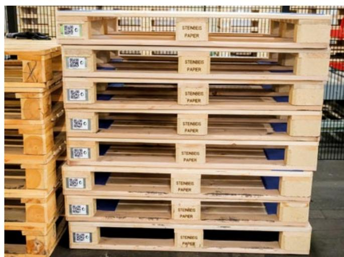
**Unterkonstruktion: Zur Steigerung der Stabilität erhalten die Palettengebinde vor der Einlagerung in das neue Logistiksystem eine Mutterpalette.**
