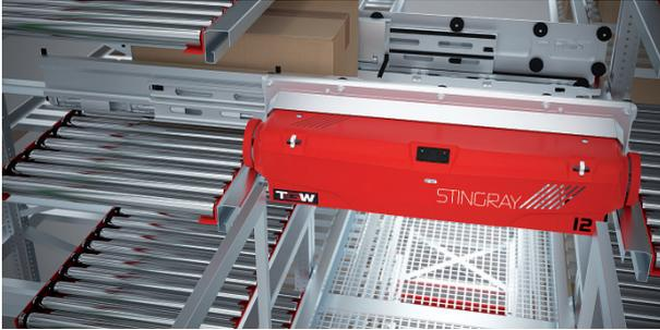
Das neue „Stingray Shuttle System“ kann modular und flexibel an die Leistungsanforderung angepasst werden. *Bild: TGW*
