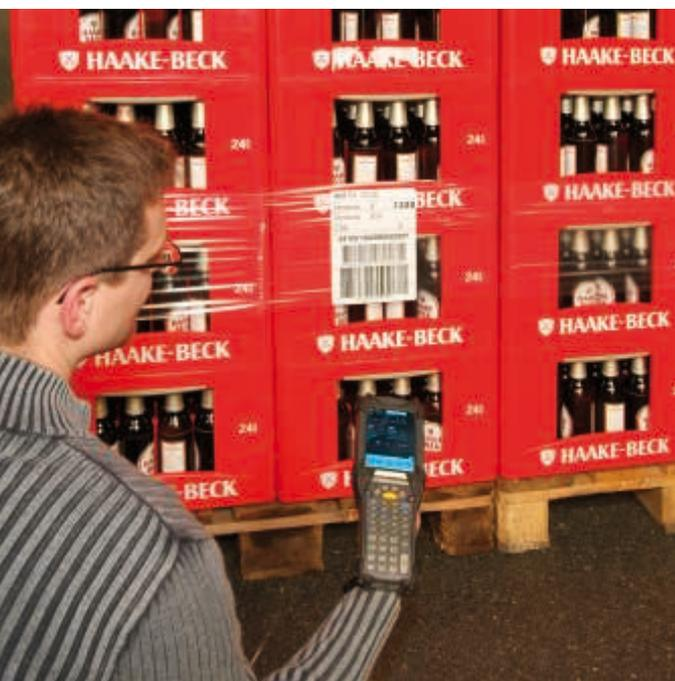
Bild 5 Datenerfassung über Handheld-Terminal im Wareneingang. Anschließend werden die Daten per Funk an SAP übermittelt.
