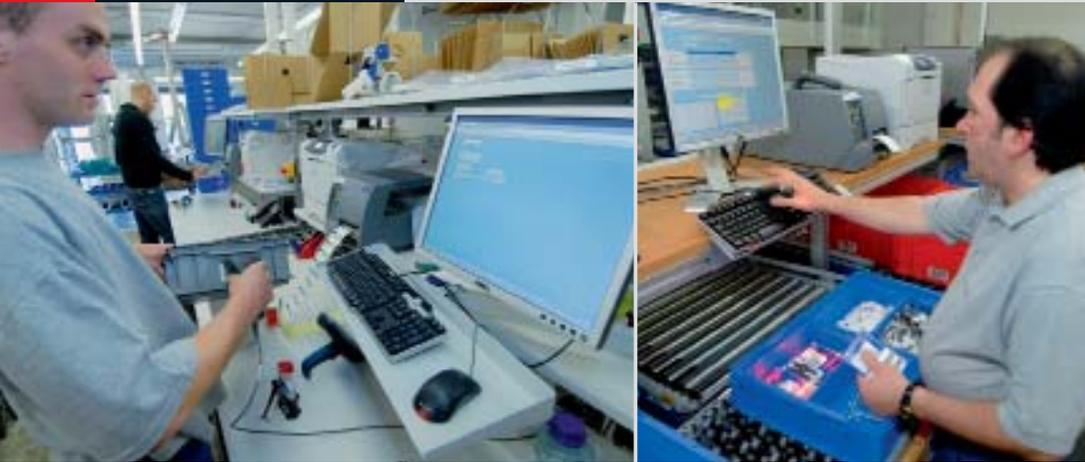
Mit der Viastore-Lösung arbeiten alle Mitarbeiter in Wareneingang, Kommissionierung und Versand über eine einheitliche Bedienoberfläche direkt in SAP. Das Kommissionieren (rechts) wird durch Lichtanzeigen erleichtert.
