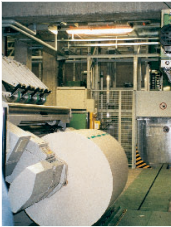
Bild 3 Die vom RFZ ausgelagerte Rolle wird über eine kurze Förderstrecke an den Rollenwechsler übergeben. Im Hintergrund erkennt man die Auslagerstation.
