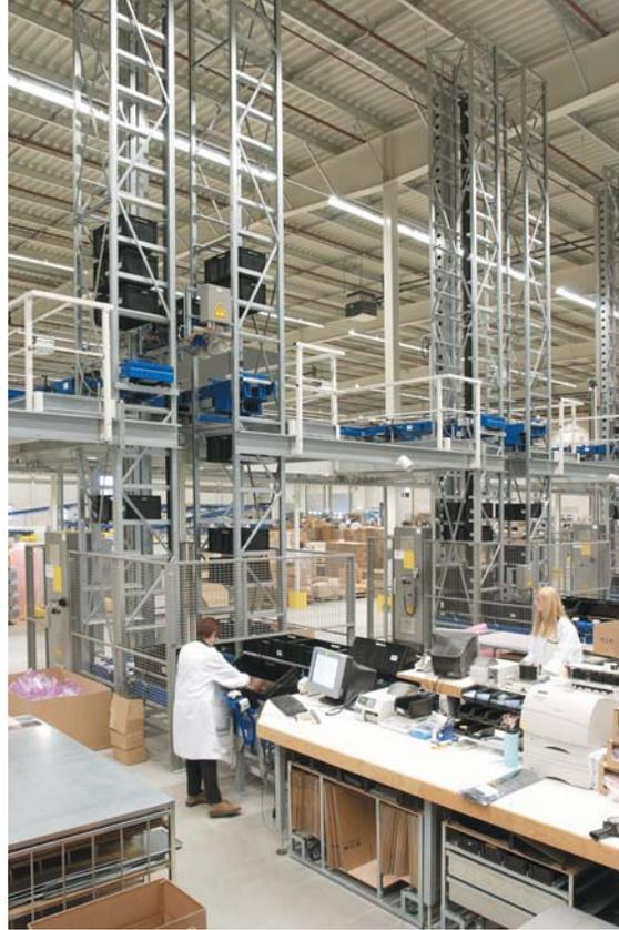
Bild 6 Workstation mit Sortierpuffer-Turmspeicher.
