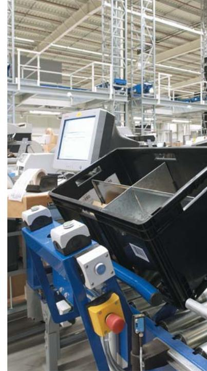
Bild 7 Die ergonomisch gestaltete Workstation. Hier erkennt man die Bleche zur Aufteilung des Behälters.
