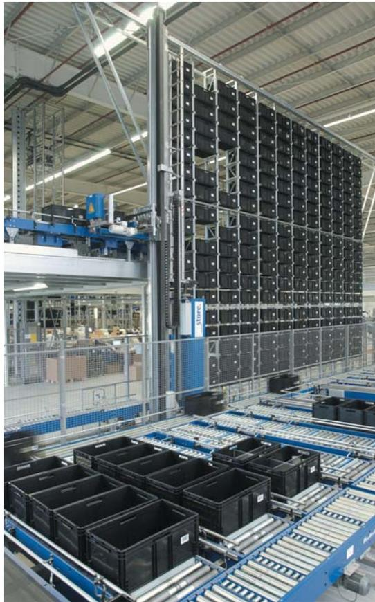
Bild 4 Die Förderanlagen verbinden den Boxenspeicher mit dem Wareneingang, um dann die befüllten Behälter in das AKL zu transportieren.
