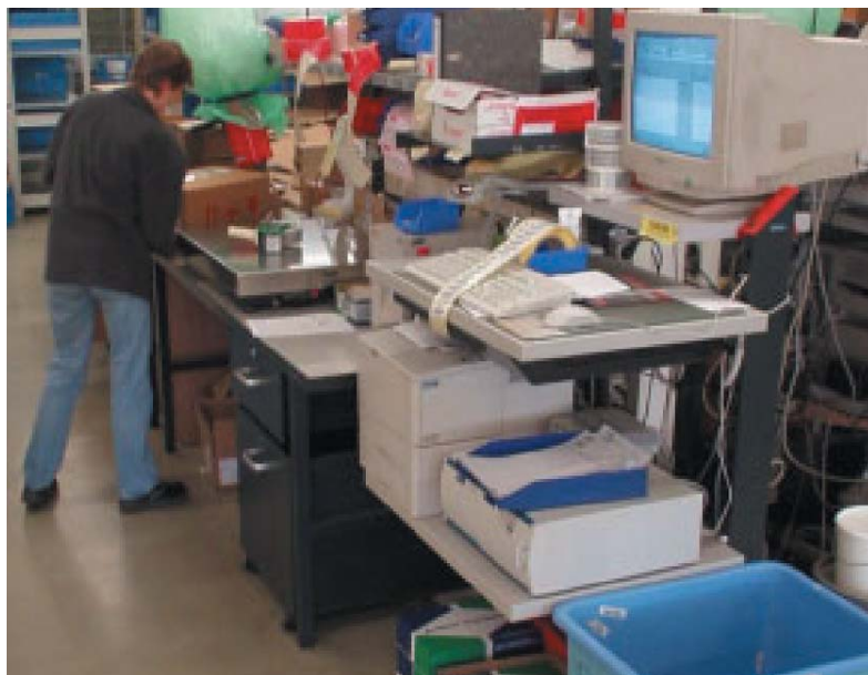
Bild 4 Die Waage am Packplatz ist online mit dem LVS verbunden. Bilder: proLogistik
