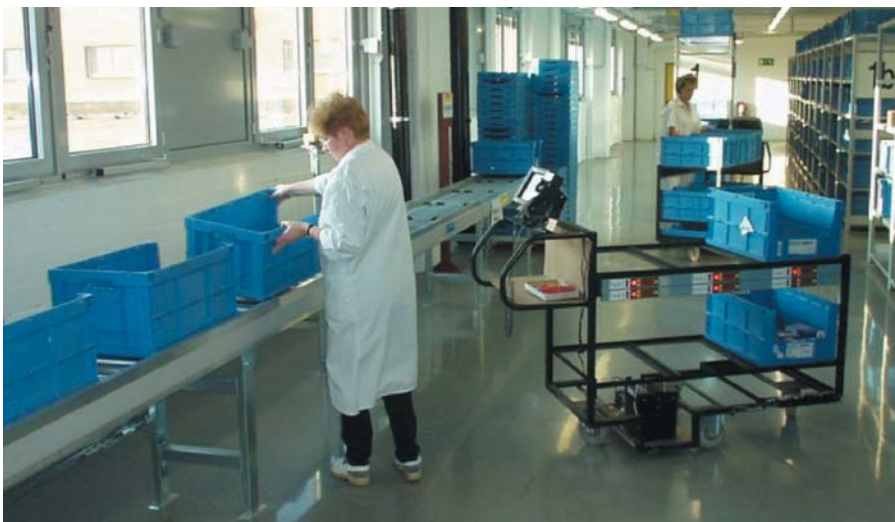
Bild 2 Über- gabeplatz zur Abgabe der kommissionierten Behälter vom Hand- wagen auf die Förder- technik im 1. OG.
