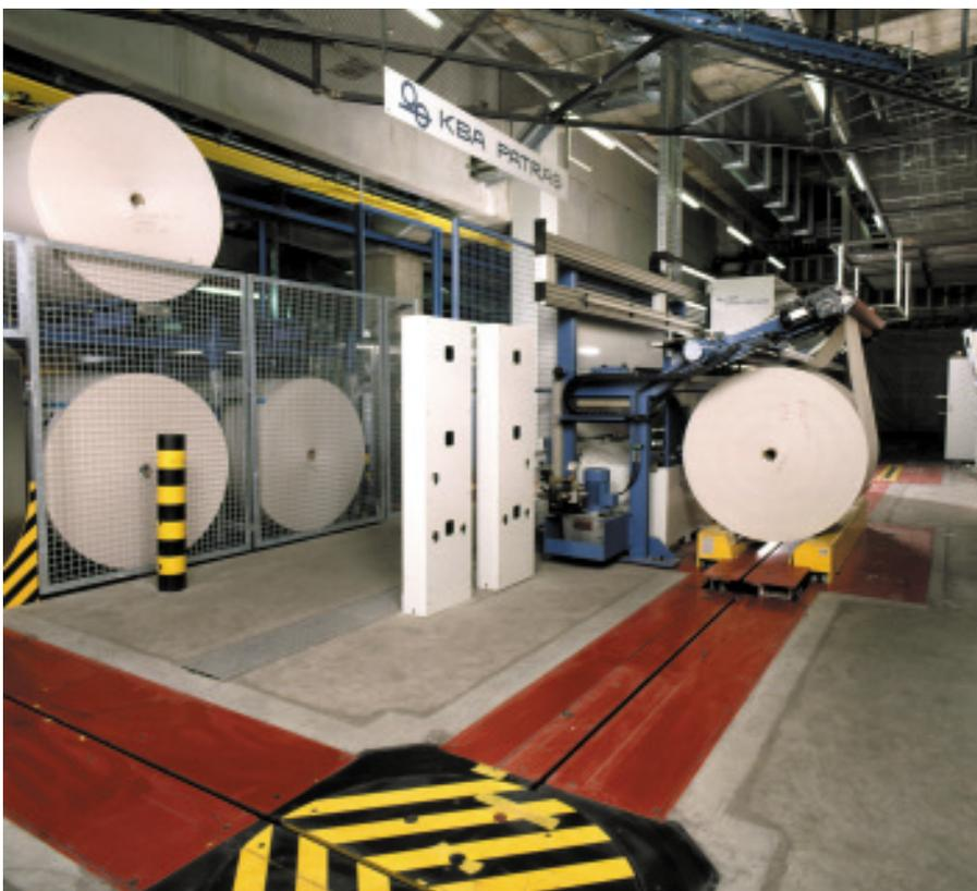
Bild 3 Auspackkreis mit Unterflurfördersystem und Tageslager.
