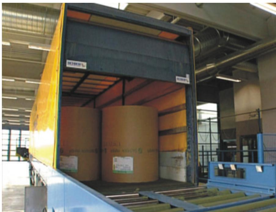
*Bild 1 Mit Hilfe von Gurtbandaufliegern können die Lkw innerhalb von Minuten entladen werden.*
