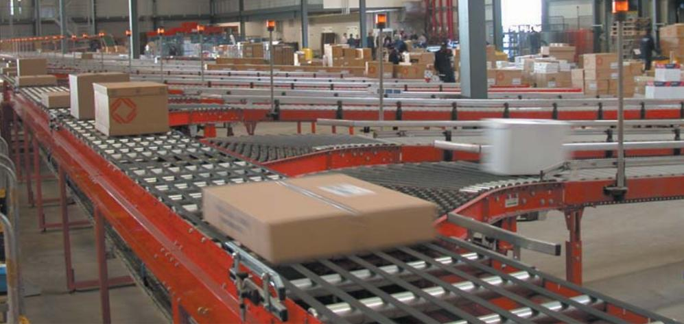
Bild 7 Endstation Sorter – von hier gehen bis 4 500 Kartons pro Stunde in den Versand. Bilder: Verfasser
