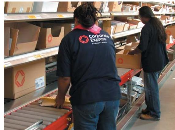
*Bild 4 Ist ein Auftrag in dieser Kommissionierschleife fertig, wird der Karton wieder auf die Förderstrecke unter den Pickplätzen geschoben.*
