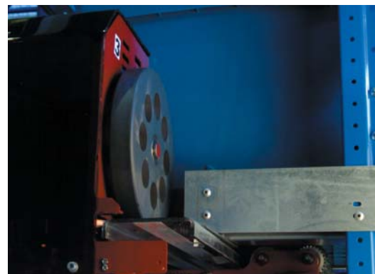
Bild 2 Das Lastaufnahmemittel umgreift die Fahrschiene.
