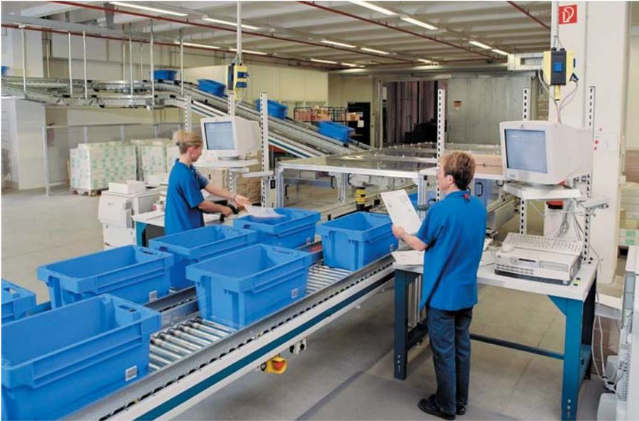
Bild 5 Aufgabepunkt für die Kommissionieraufträge an die Fördertechnik.
