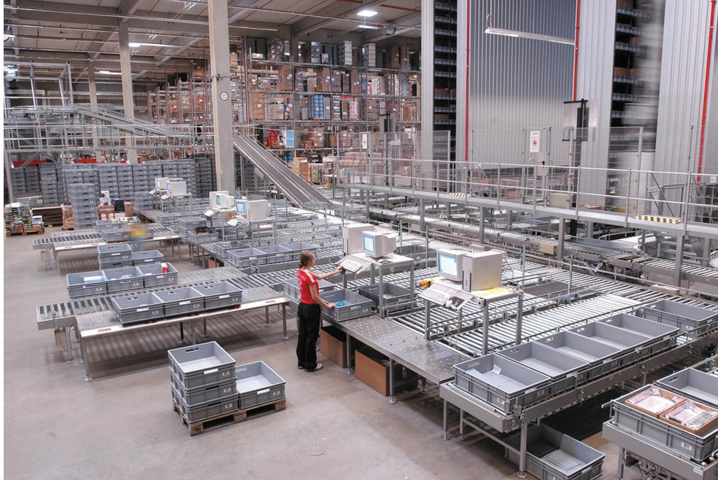
*Bild 3* An den Kommissionierplätzen vor dem AKL können in Spitzenzeiten bis zu fünf Aufträge gleichzeitig bearbeitet werden.
