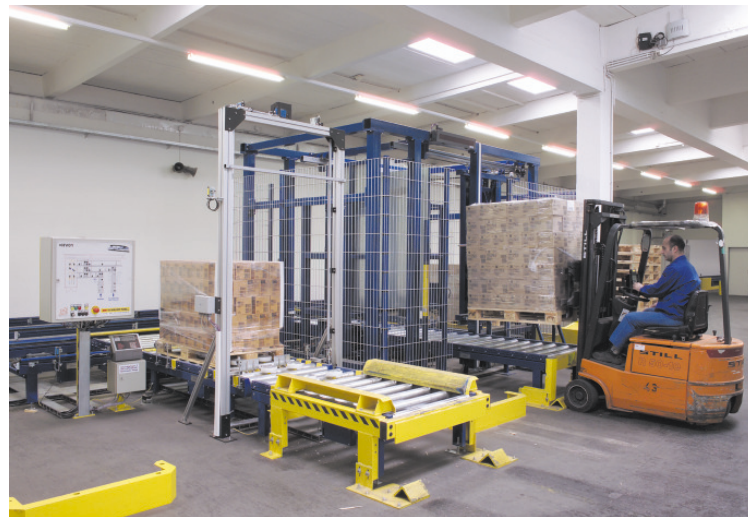
Bild 3 Paletten-Auf- und Abgabestation mit Palettenzentrierer.
