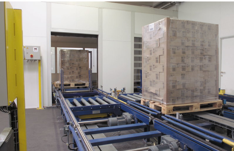
Bild 2 Durch eine Schleuse ist das Sauerstoff-reduzierte HRL von der Ein- und Auslager-Zone getrennt.
