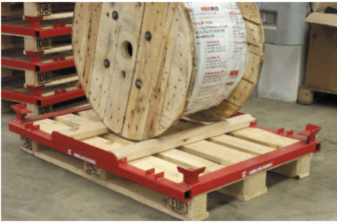
Bild 5 Mit Hilfe des selbst entwickelten Systemrahmens können die Kabeltrommeln stehend transportiert und gelagert werden .Bilder 3 bis 5: Siemens L&A
