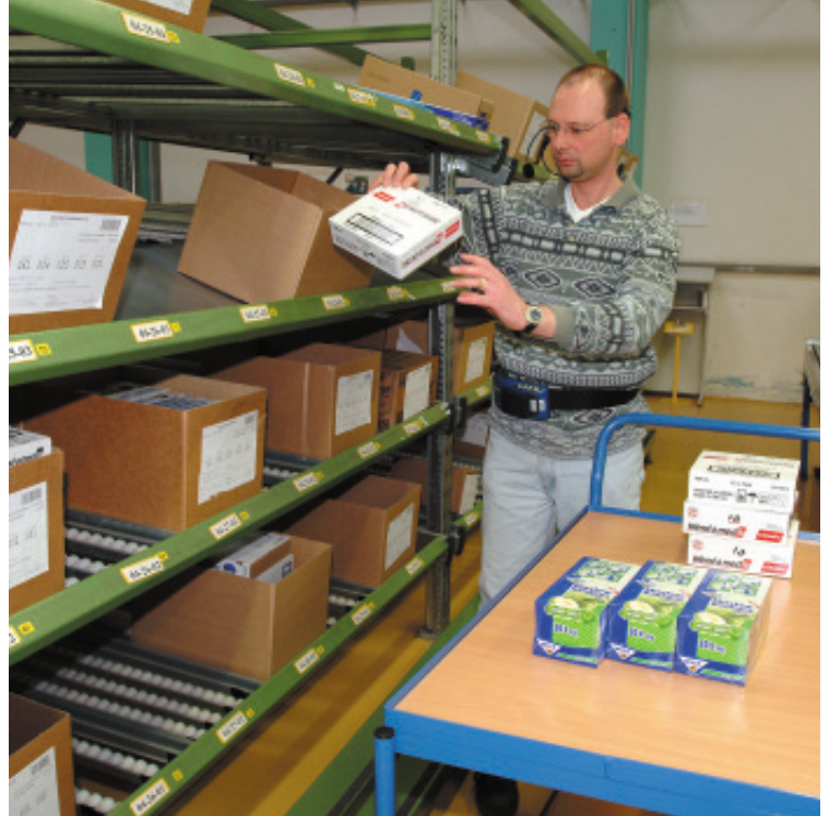
Bild 5 Alle Regalplätze für die Pick-by-Voice-Kommissionierung sind mit einer weißen Platzkoordinate und einem gelben zweistelligen Prüfciffern-Schild ausgestattet.
