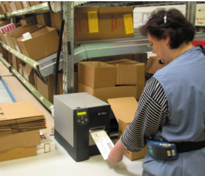
Bild 4 Die Anforderung des Kommissionier- und Versand-Etiketts wird ebenfalls über das Voice-Systems gesteuert.
