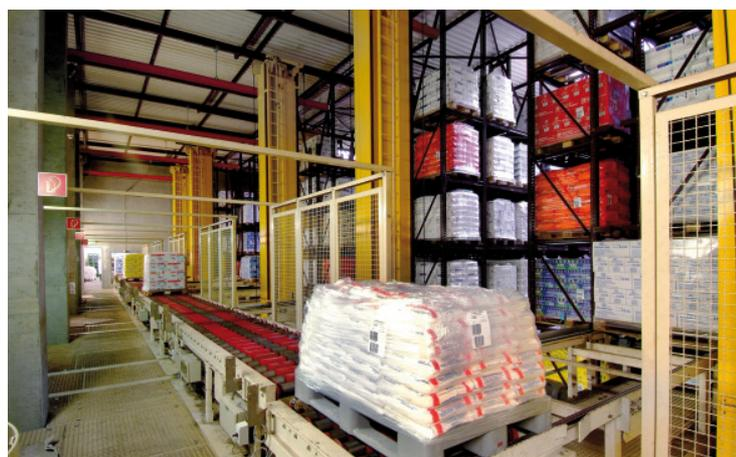
**Bild 1** Über eine Förderstrecke gelangen die Siedesalzprodukte aus der Produktion direkt ins HRL. Aufgrund des Dreischicht-Betriebs muss die Verfügbarkeit daher stets sichergestellt sein.
