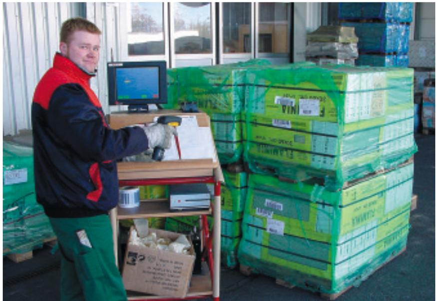
Bild 3 Im Wareneingang wird die Ware nach einer Mengen- und Qualitätsprüfung mit einem Barcode versehen und kann von diesem Augenblick an lückenlos bis zum Kunden verfolgt werden.
