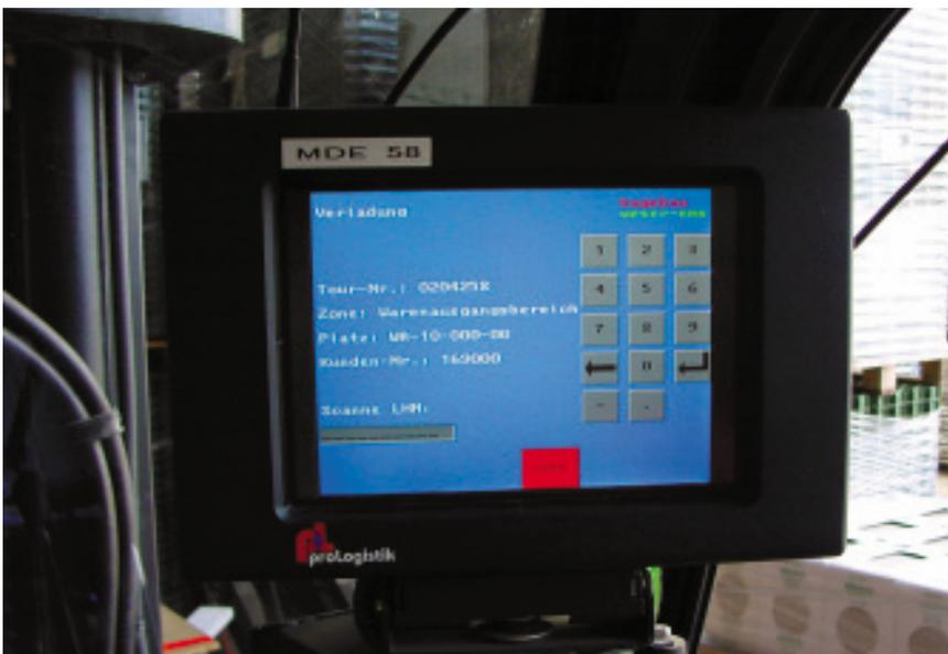
Bild 2 An jedem Gabelstapler und Kommissionierfahrzeug sind die nötigen Informationen für jeden Arbeitsauftrag direkt auf einem Monitor verfügbar.
