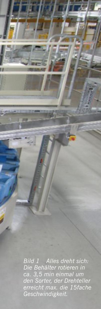
Bild 1 Alles dreht sich: Die Behälter rotieren in ca. 3,5 min einmal um den Sorter, der Drehteller erreicht max. die 15fache Geschwindigkeit.
