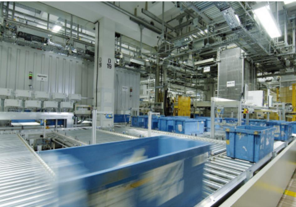
Bild 5 Die Behälterfördertechnik ist in insgesamt vier Ebenen realisiert und hat bei einer Grundfläche der Anlage von ca. 35 x 30 m eine Gesamtlänge von mehr als 400 m.
