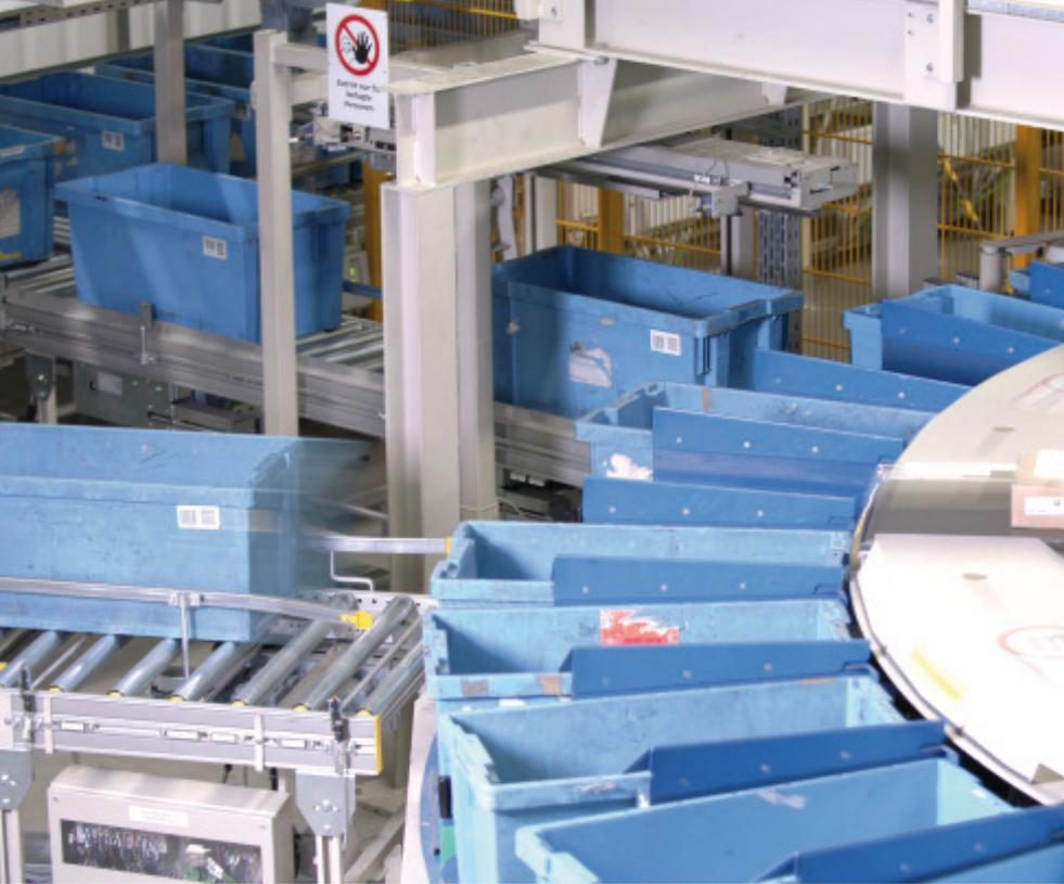
*Bild 2 Die automatische Ver- und Entsorgung ermöglicht eine virtuelle Vervielfachung der Anzahl der nutzbaren Zielstellen sowie dynamische Behälterwechsel ohne Eingriff des Personals.*
