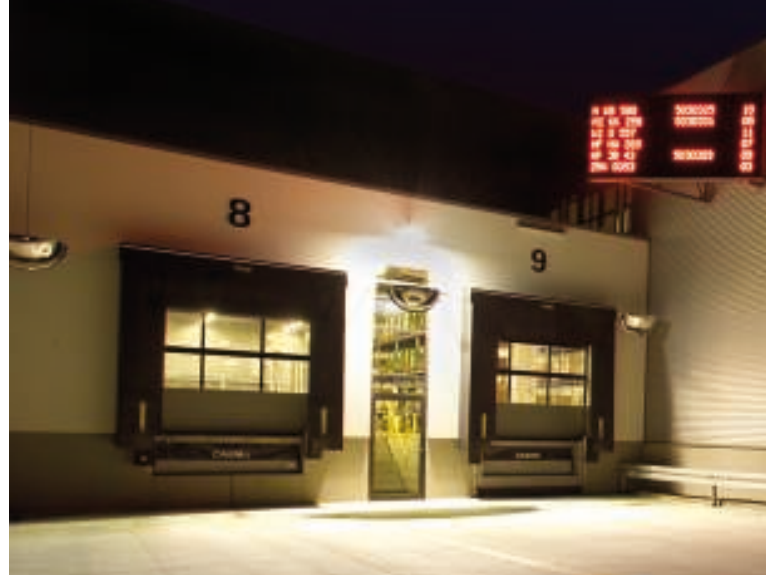
Bild 5 Das Hettich Logistikzentrum bei Nacht: Die Anzeigetafel wird über das Yard-Management-System gesteuert und weist den Lkw-Fahrern die richtige Rampe zu.
