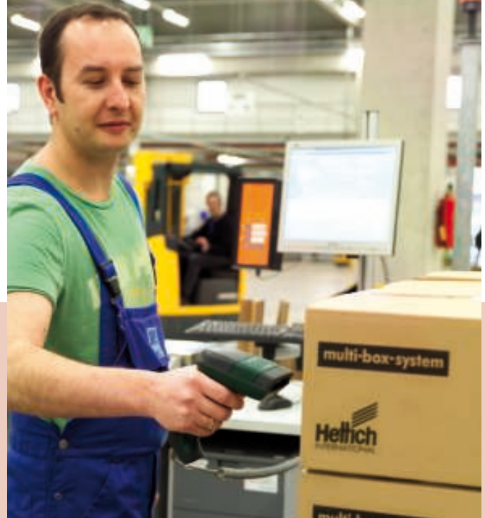
Bild 3 Alle Kommissionierplätze sind mit integrierten Systemkomponenten ausgestattet und geben dem Mitarbeiter über ein Display exakte Informationen über Kommissionier- und Verpackungsvorgaben.
