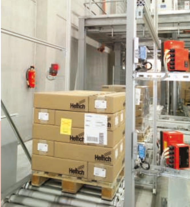
Bild 2 Automatisierte Wareneingangs-Prüfung mit Multi-Direktionaler-Scanner-Erfassung des Warenbegleitscheins sowie automatischer Gewichts- und Konturenkontrolle.
