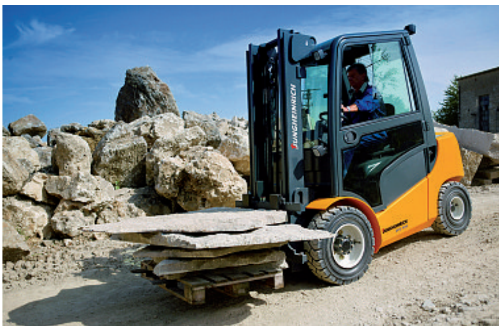
Der DFG 430 überzeugt durch hohe Fahrstabilität dank des extrem niedrigen Schwerpunkts und seiner Sicherheitslenkachse.
