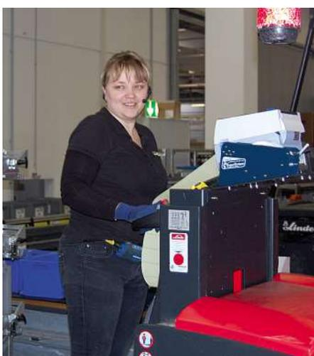
**Zur Unterstützung der Kommissionierung wird ein Pick-by-Voice-System eingesetzt.**
