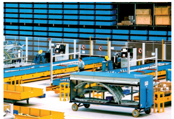
Im Vordergrund des Langgutlagers stehen kommissionierte Spanten auf einem Wagen zum Transport in eine Montagehalle bereit.
