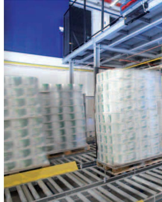
*Zur Übernahme im Verladebereich werden die Paletten automatisch von Verschiebewagen auf Rollenbahnen übergeben.*
