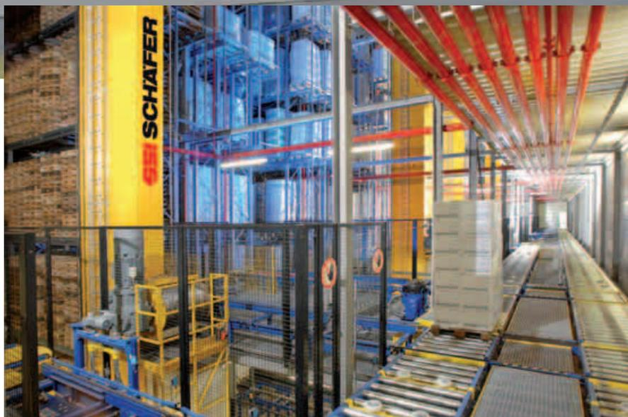
*An speziellen Übergabepunkten werden die Paletten aus dem Wepa-HRL von den RBG direkt auf die Fördertechnik übergeben, die die Paletten bis zu den Verladeplätzen transportiert.*
