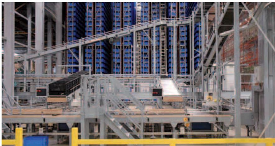
An den beiden äußeren Seiten des AKL sind die 800 Kommissionierdurchlaufkanäle der sechs Zone-Pick-System-Zonen angebracht - jedes Fach hat ein Pick-to-Light-Modul.
