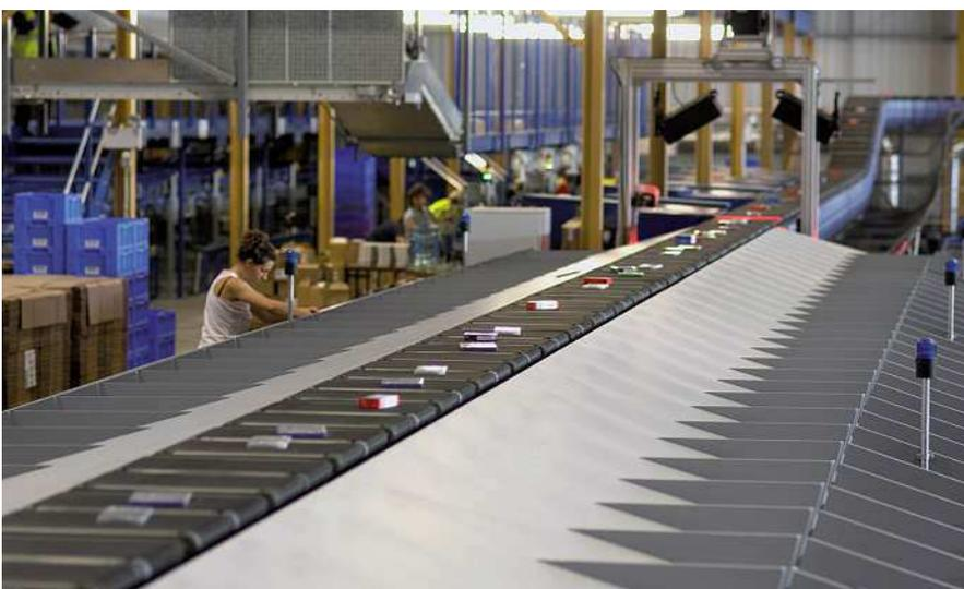
*Der Cross Belt Sorter bietet die nötige hohe Flexibilität, um an Änderungen der Software-Verpackungen angepasst zu werden.*
