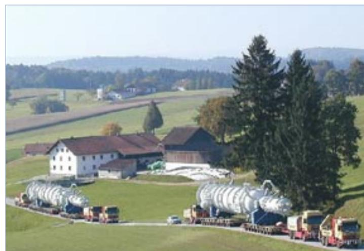
Die Linde AG produziert komplexe Anlagen mit 45m Länge, bis zu 6m Durchmesser und einem Gesamtgewicht von rund 170t.
