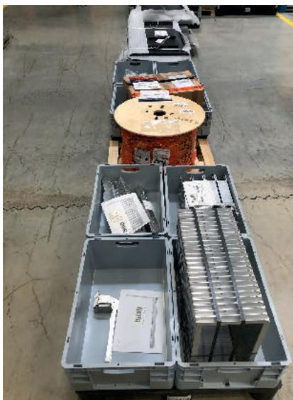
**Bild 6** Die Auftragskonsolidierung der Produktionsabrufe erfolgt in Behältern auf Paletten. Foto: PSI
