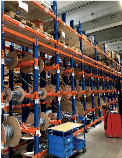
**Bild 5** PSIWms verwaltet die Bestände im Kabelregal und steuert die wegeoptimierten Kommissionierprozesse für Meterware von den Kabeltrommeln. Foto: PSI
