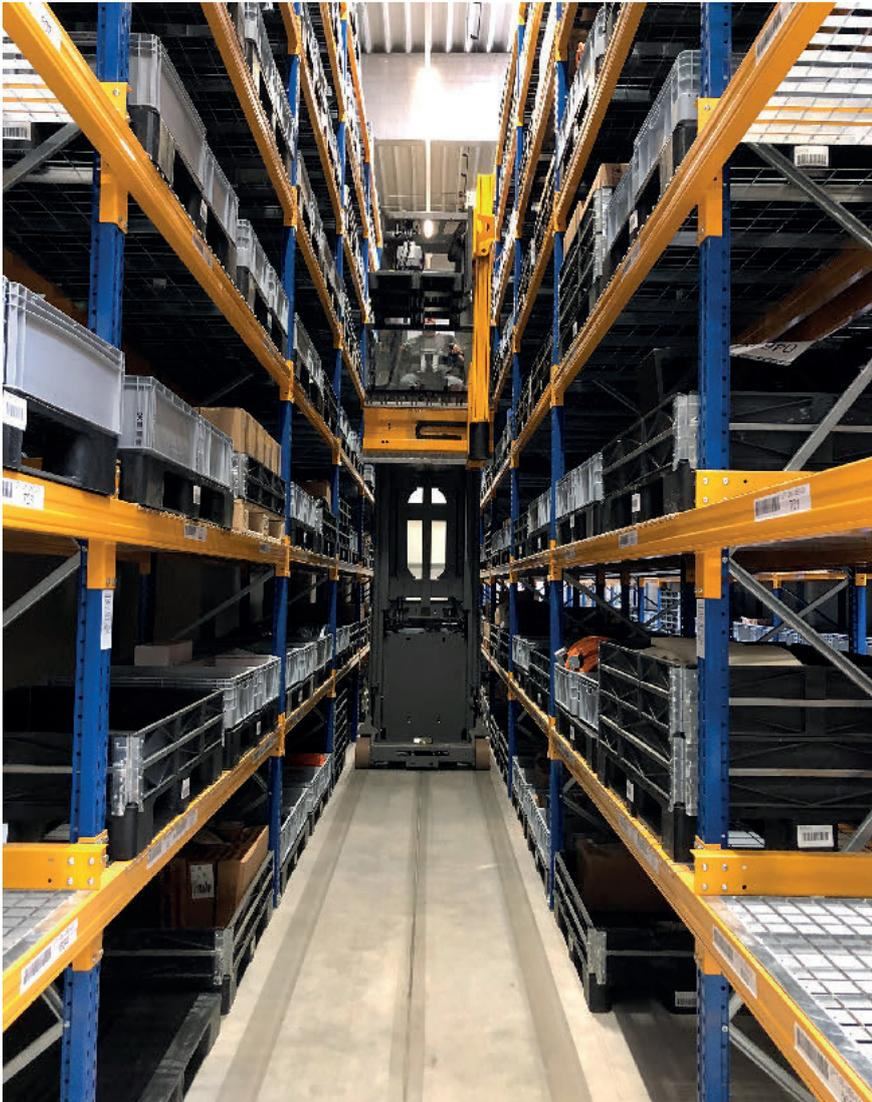
**Bild 4** Im zweigassigen Schmalganglager stehen rund 1 250 Palettenstellplätze zur Verfügung. Foto: PSI
