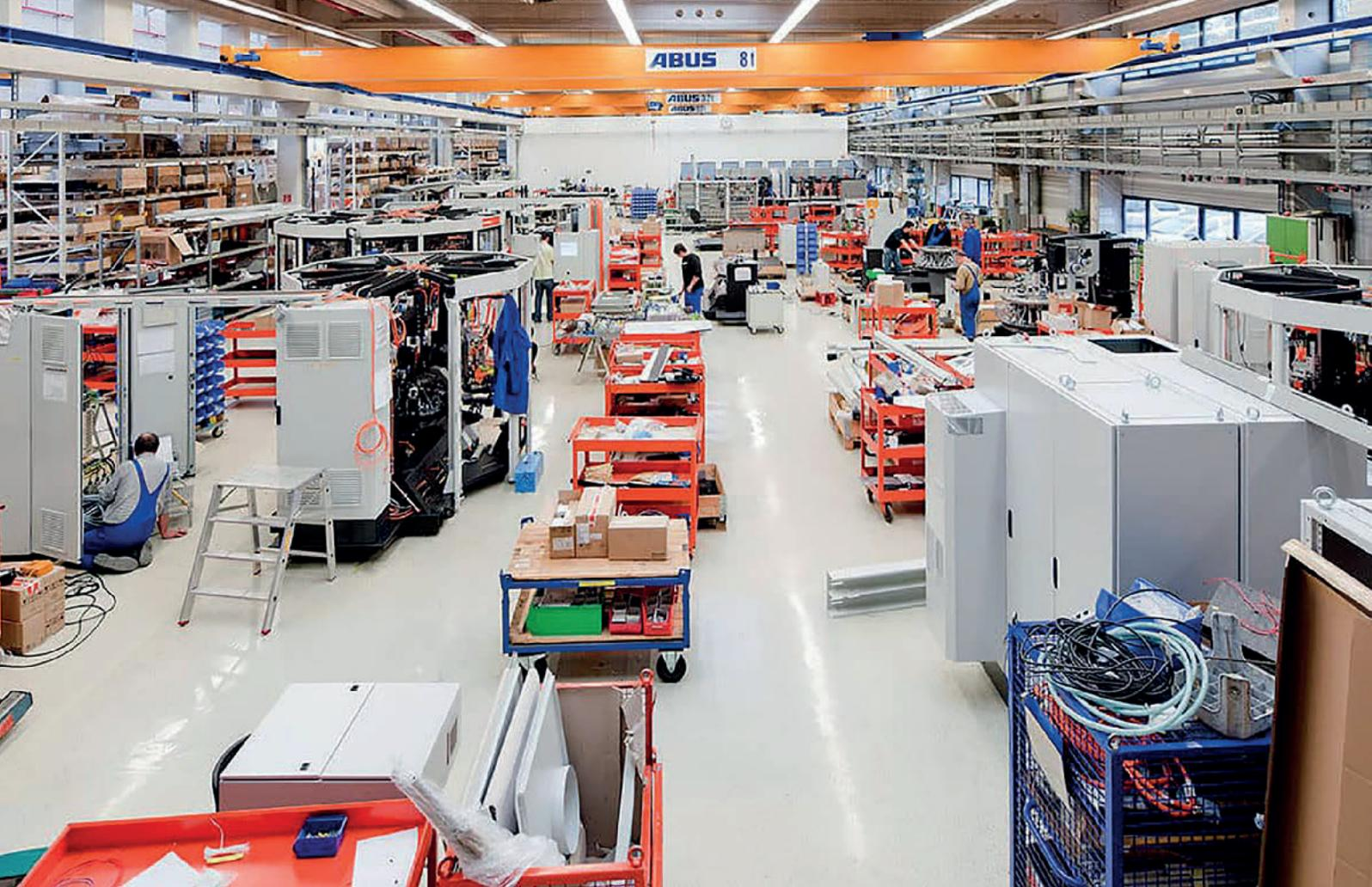
**Bild 1** Die Montageplätze der Service- und Upgrade-Halle bei KBK werden aus PSIWms auf Abruf mit koordinierten Materialtransporten versorgt. *Foto: PSI*
