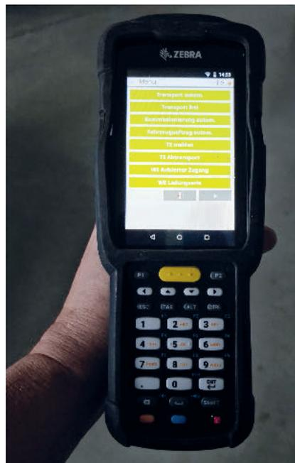
**Bild 3** Mit mobilen Datenterminals werden die Ein- und Auslagerungsprozesse quittiert und neue Ein- und Auslagerungs- oder Kommissionieraufträge darauf übermittelt. Foto: PSI
