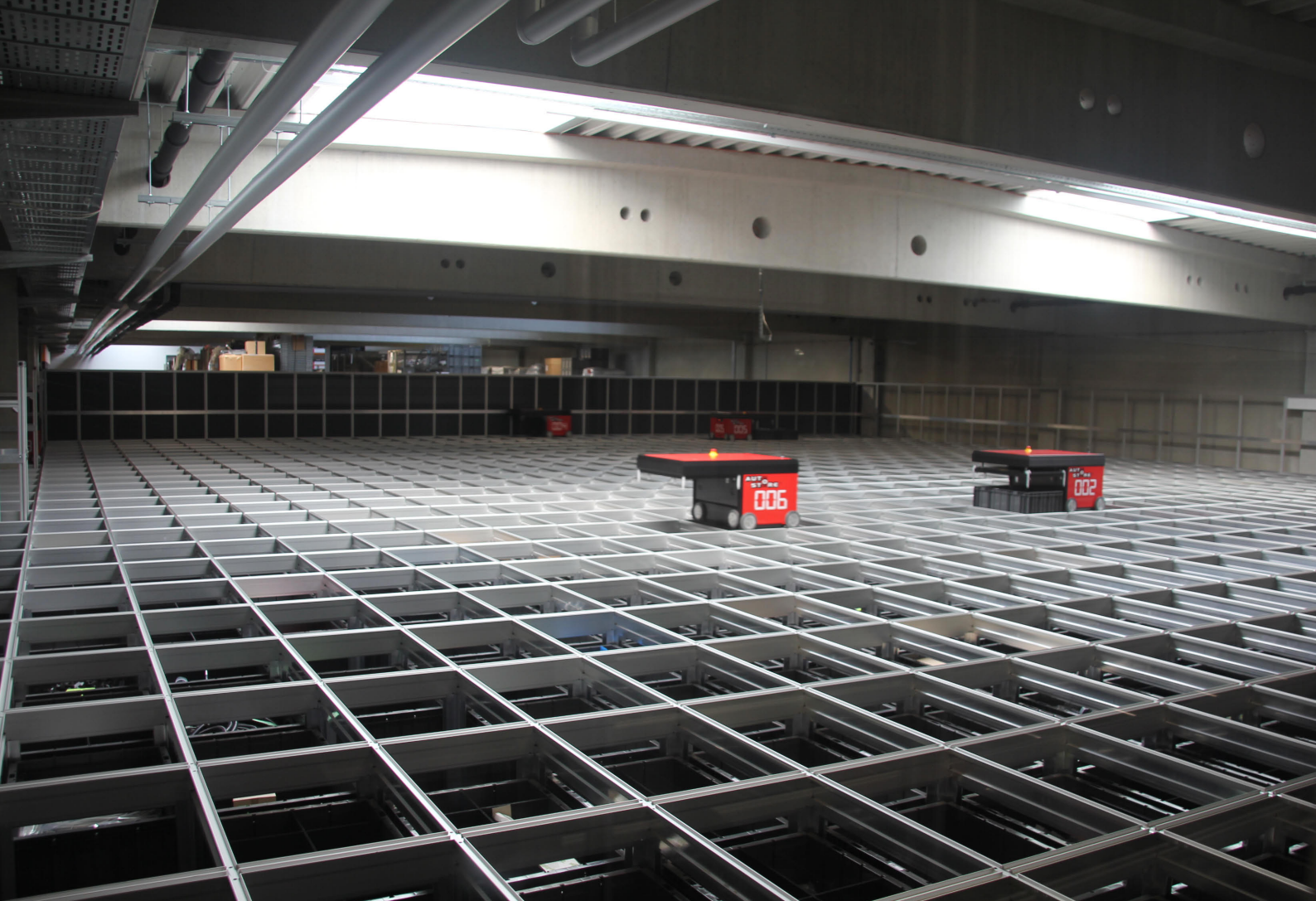
Bild 1 Durch die Anbindung der speicherprogrammierbaren Steuerungen (SPS) an PSIWms lässt sich die Performance des AutoStore-Systems um bis zu 20 Prozent steigern. Foto: elobau
