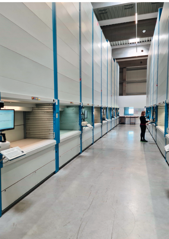
Das Lager verfügt über 18 Shuttle-Tablarlager mit insgesamt rund 15.000 Lagerfächern.
