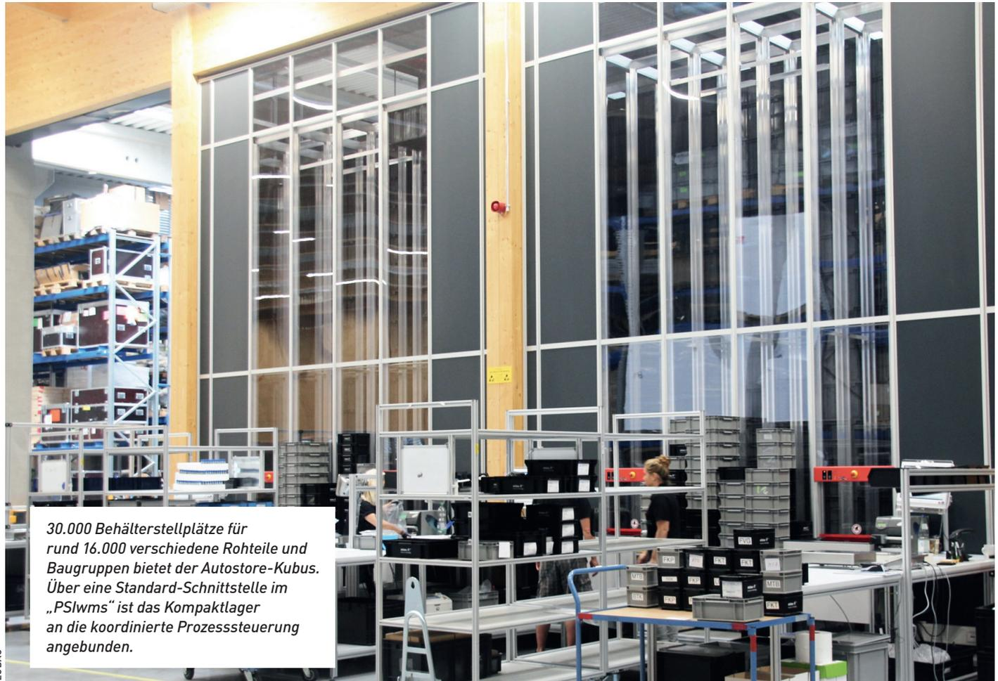
*30.000 Behälterstellplätze für rund 16.000 verschiedene Rohteile und Baugruppen bietet der Autostore-Kubus. Über eine Standard-Schnittstelle im „PSIwms“ ist das Kompaktlager an die koordinierte Prozesssteuerung angebunden.*
