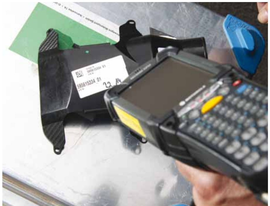
Mit Hilfe der Barcode-Scanner wird jeder Austausch eines Teils erfasst.
