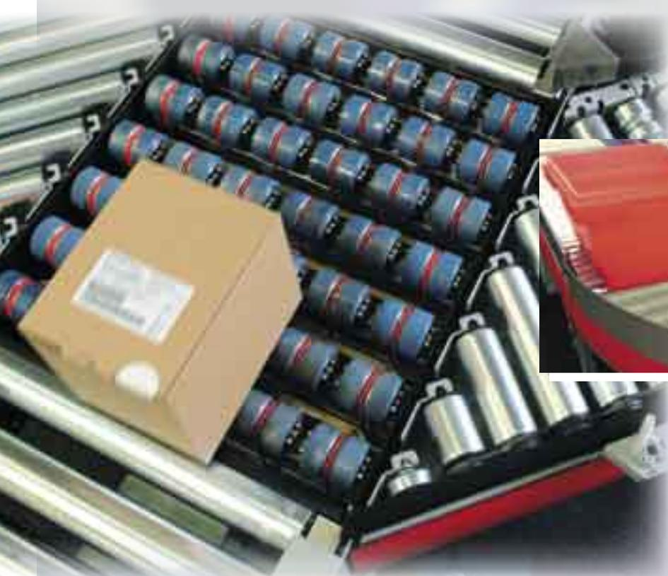
Flexible Einsatzmöglichkeiten bietet die von SSI Schäfer Peem neu entwickelte Fördertechnik. Ob Kartons, Behälter oder beides zusammen, befördert werden Einheiten ab 180 mm Länge im Bodenmaß und bis 50 kg Inhaltslast.
