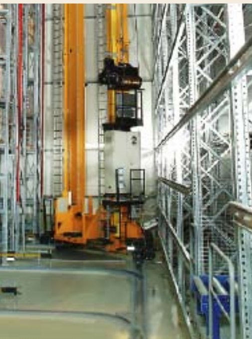
Kurvengängige Regalbediengeräte sorgen für effiziente Ein- und Auslagerung.
