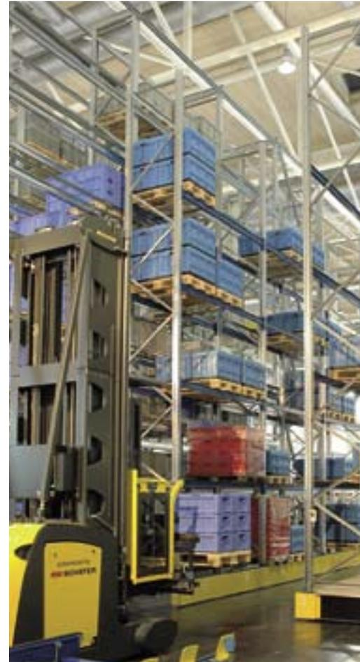
Eine viel beachtete Weltpremiere feierte das „automatisierte Verschieberegale“. Das System besteht aus den Komponenten: Verschieberegalanlage, lasernavigierter Schmalgangstapler, Verkehrsmanagementsystem und Materialflussrechner für die fördertechnische Anbindung sowie Fördertechnik.
