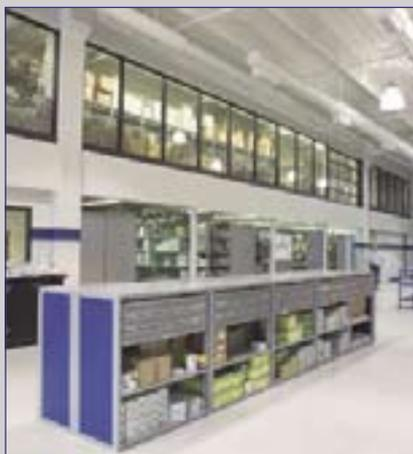
Auch das Handling der Ersatzteile sollte ausgebaut und optimiert werden. Dazu mussten Ersatzteile im Wert von über 1.3 Millionen US\$ vom ehemaligen Lager in die neuen Räumlichkeiten wechseln. Der 5-Feld breite Lagerlift Pickomat® von SSI Schäfer sorgt für schnellen und direkten Zugriff auf alle Kleinteile, die hier besonders kompakt untergebracht sind.
