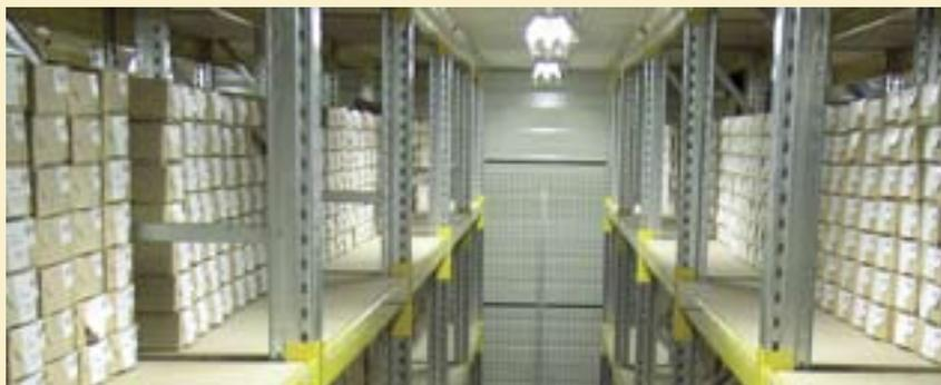
Auf dem gegebenen Raum mit einer Fläche von 24 x 40 Metern wurde eine fünfgeschossige, 14 Meter hohe Bühnenanlage integriert, in welcher 170.000 Archivkartons für Banken und Versicherungen in einem Großfachregalsystem Platz finden.
