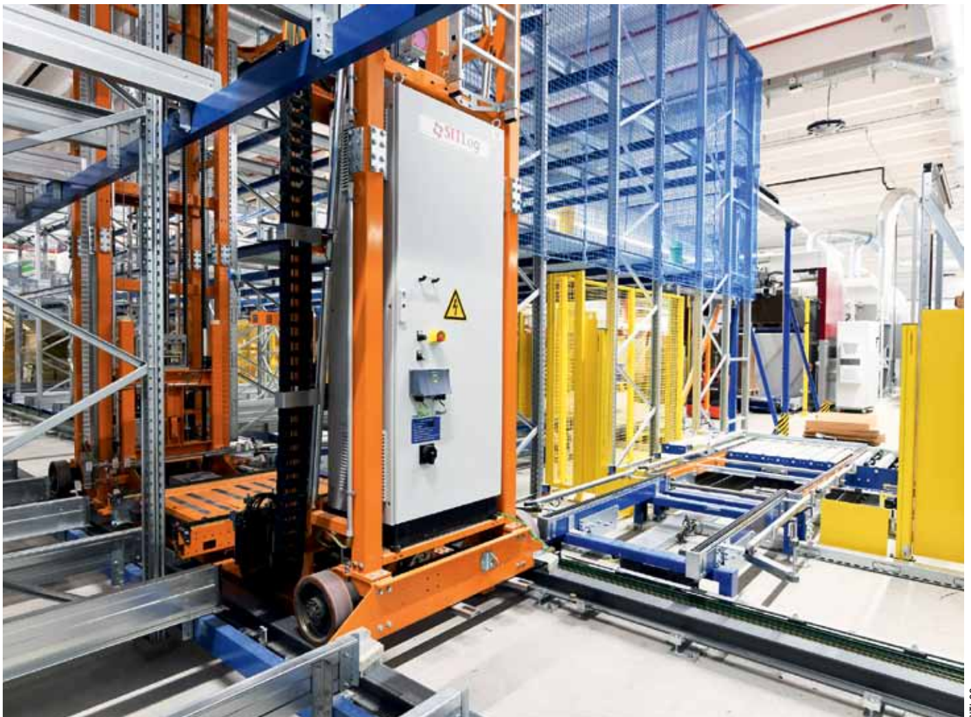
Satellitenlager im EG zur Versorgung der Produktionsmaschinen mit Kartonagen
