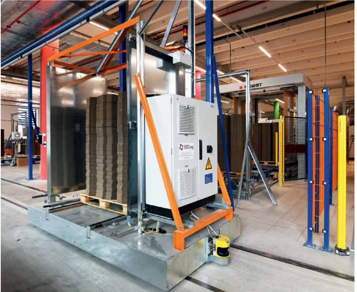
Einer von insgesamt fünf freifahrenden QVW. Diese sind für Leistungen zwischen 60 und 170 Paletten pro Stunde ausgelegt.
