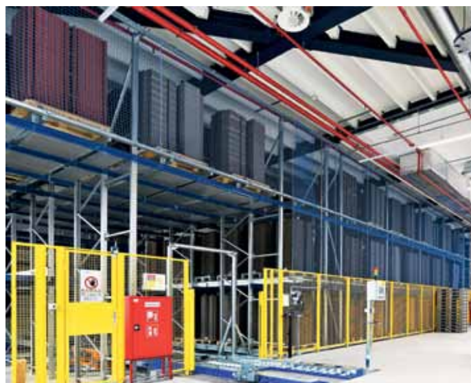
Das im 2. OG neu erstellte Satellitenlager zur Pufferung der gestanzten Wellpappenbögen vor deren Weiterbearbeitung
