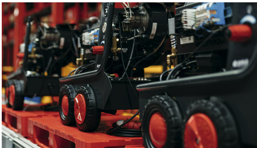
EHRLE • Montage von Heißwasser-Hochdruckreinigern (Ectronic II)
