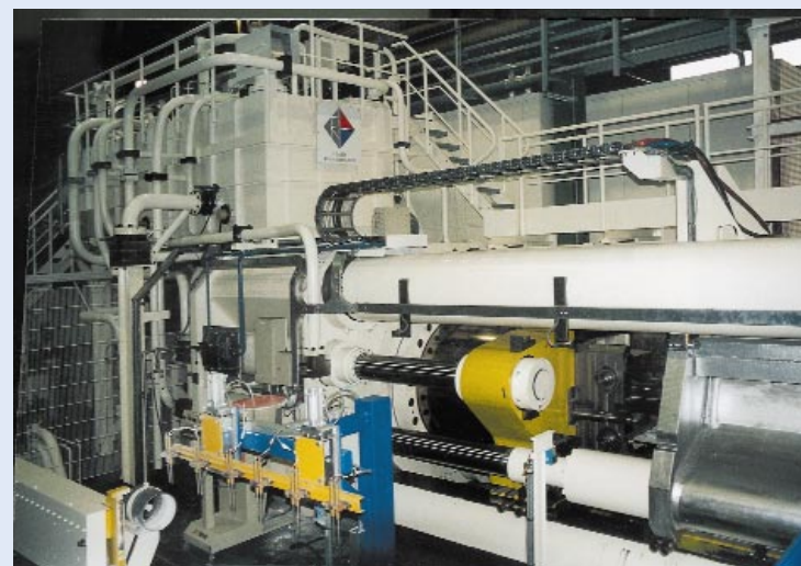
Die 44 MN Strangpresse kann auch als Rohrpresse eingesetzt werden
