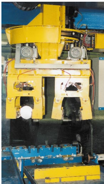
Erbslöh Aluminium GmbH: Aufnahme des Blockes durch den Blockmanipulator
