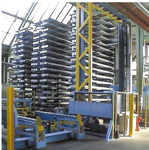
Die Kapazität des Rundbarrenlagers liegt bei über 425 Barren
