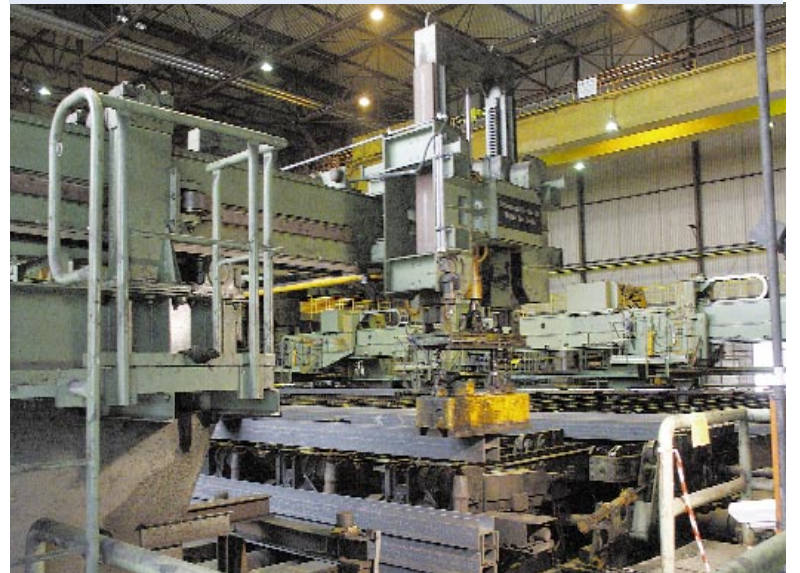
Magnetschwenkarm, der die Profile zu Paketen stapelt
