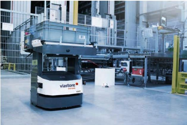
▲ Die Open Shuttle-Lösung von Viastore bietet eine flexible und platzsparende Möglichkeit, verschiedenen Bereiche und Prozesse im Lager zu vernetzen. Die fahrerlosen Transportfahrzeuge versorgen die Kommissionierplätze automatisch mit Nachschub und transportieren die Produkte selbstständig zur Einlagerung ins AKL (Fotos: Viastore)
