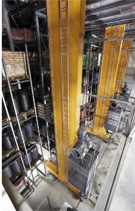
▲ RBG in Modulbauweise erlauben eine flexible Anpassung an individuelle Anforderungen (Bild: Dambach)
