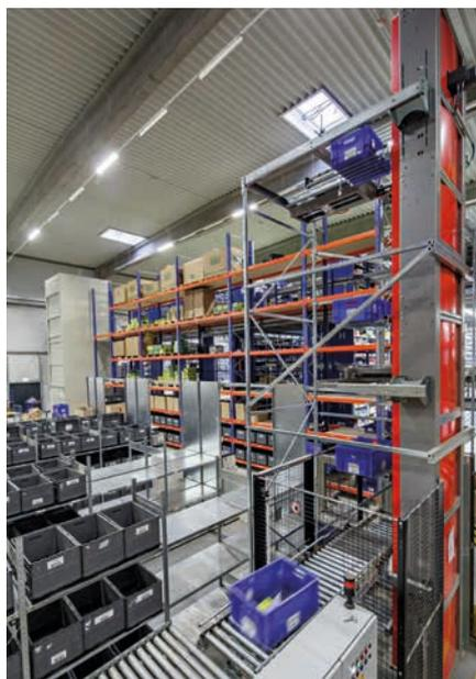
▲ Systemregale in Steckbauweise können leicht aufgebaut, verändert und erweitert werden (Bild: F.X. Rauscher)
