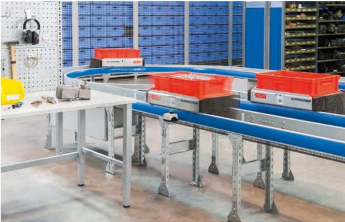
◀ Der Autocruiser schließt die Lücke zwischen Staplertransporten und konventioneller Fördertechnik (Bild: SSI Schäfer)
