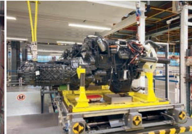
Ein Lift hebt die Antriebsstränge in das obere Stockwerk, wo sie zur Montagelinie gebracht werden
