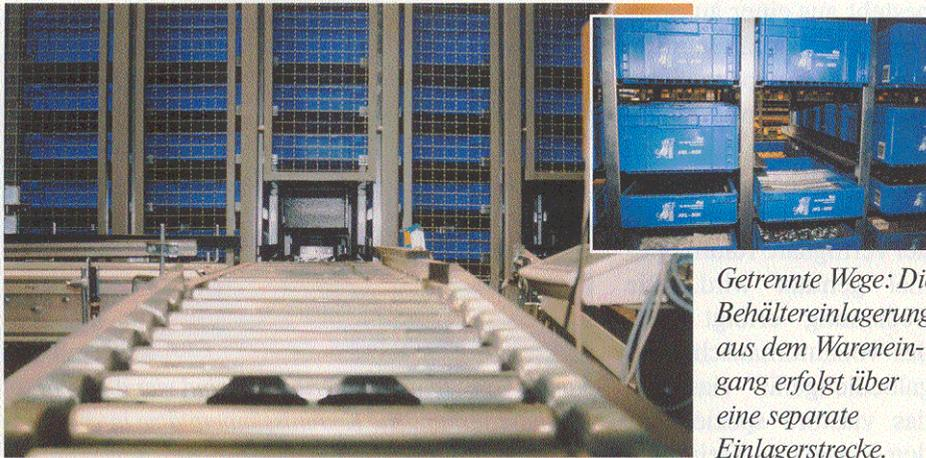
*Getrennte Wege: Die Behältereinlagerung aus dem Wareneingang erfolgt über eine separate Einlagerstrecke.*
