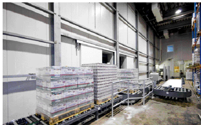
Auf dem Rollenkettenstauförderer bereitgestellte Paletten
