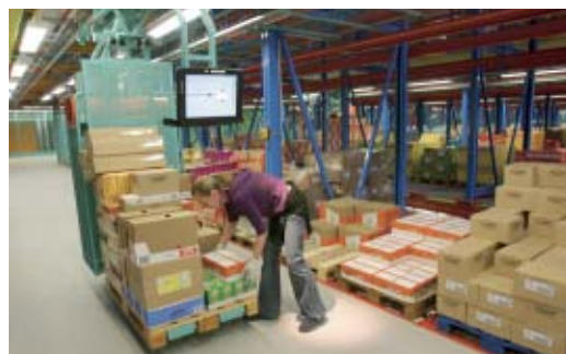
Intelligentes Pick-Mobil: Jede Gewichtsabweichung wird dem Kommissionierer am Bildschirm gemeldet
