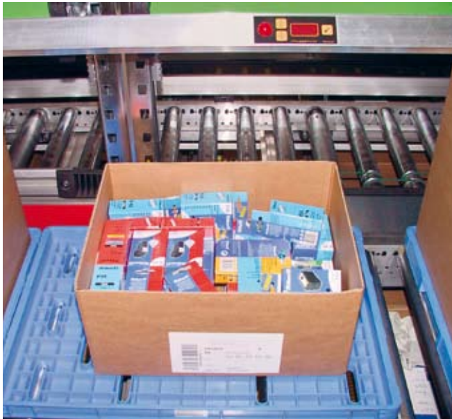
□ Automatische Behälterbereitstellung in der Kommissionierzone
