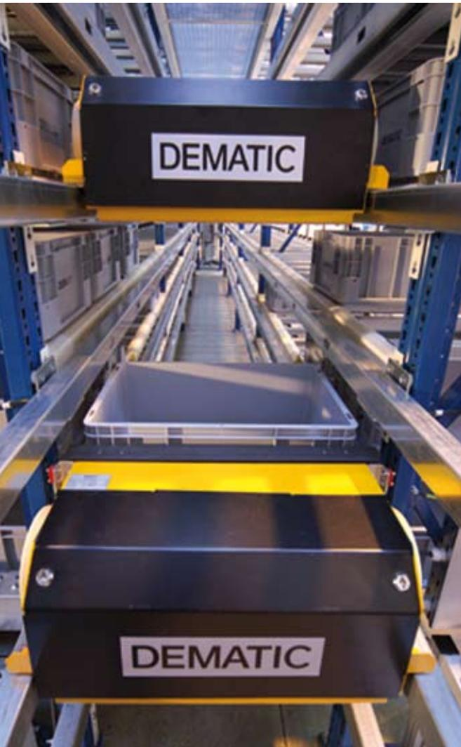
Multishuttle-System beim finnischen Fleischlieferanten HK Ruokatalo. Im Hintergrund die Lagermaschine, vorn das Split-Case-Picking-Modul mit 28 Pickstationen.
